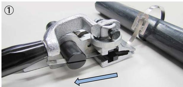
バンドを対象物に巻き付け、バンドをバックルに通して、工具の先に差し込んで、テンション軸の溝に入れます。
