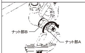
③ナット部Bが動かないように「レンチ」などで押さえたまま、ナット部Aを「レンチ」などで締め付けます。
