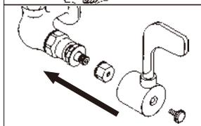
④②の逆の手順で、六角インサート・レバーハンドルを取り付け、ビスを締め付けます。
