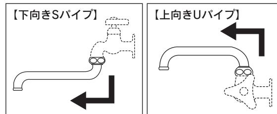
\* 水栓の種類によって、取り付けるパイプの種類が異なります。ご使用中の水栓をご確認の上、お求めください。
