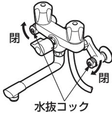
すべての水抜コックが閉まっていることを確認し、切替ハンドルのレバーを時計回り（スパウト側）に回し、湯側・水側ハンドルを閉めて（水が出ない状態）から通水を再開してください。
