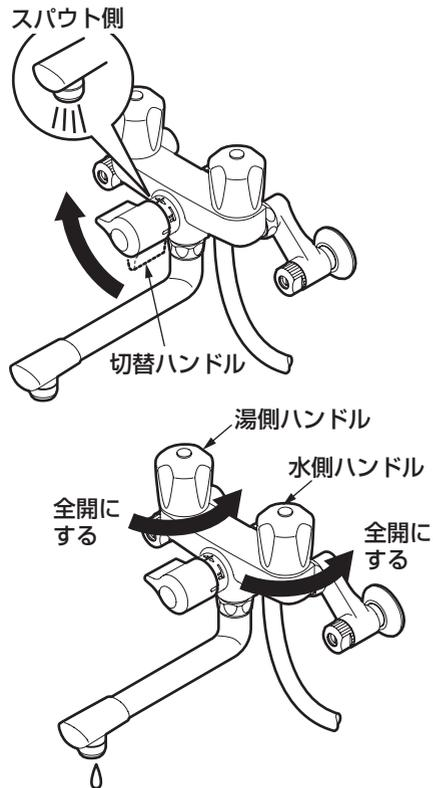
1. 配管部の水抜栓などにより通水を止めて、水抜きを行う。
