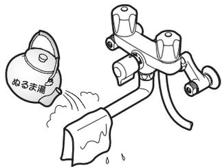
水抜きを行っても吐水口の網目に付着した水滴が凍り、通水後も少しの間、水が出ない場合があります。そのときはタオルなどの布を巻き付け、しみこませるようにゆっくりとぬるま湯をかけてください。
