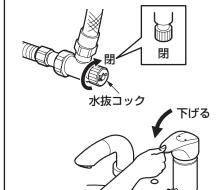
水抜コックが閉まっていることを確認し、 レバーハンドルを下げて(水が出ない状態) から通水を再開してください。
