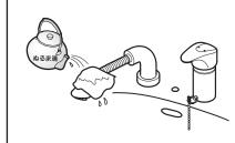
水抜きを行っても吐水口や泡まつキャップ の網目に付着した水滴が凍り、通水後も少しの間、水が出ない場合があります。 そのときは、吐水口を引き出し、タオルなど の布を巻き付け、しみこませるようにゆっく りとぬるま湯をかけてください。
