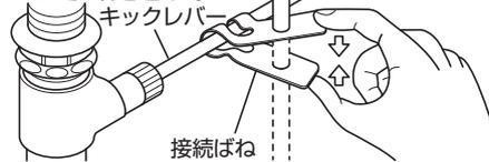
2. 接続ばねを図のように折り曲げないでください。(引棒がずれる原因となります。)
