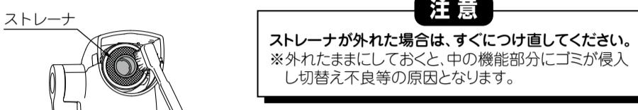
3. ボールなどの器に清潔な水道水をため、ストレーナが沈む程度に浸けて、軽くすすぐ。
