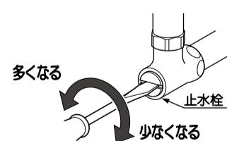
2. 湯と水の流量が同じになるように、水側の流量調節栓を調節する。
