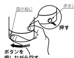
2. カバーリングの穴の位置を皿小ねじに合わせ、皿小ねじを外し、本体を抜く。
