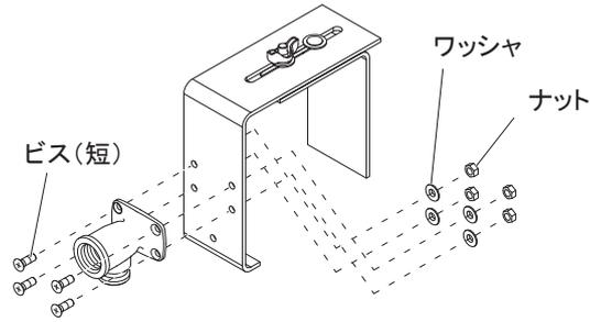
②取付ける対象物の厚みに合わせて本体の固定板の向きを決定します。
