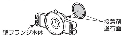
※壁フレンジの突起部を器具中心線に合わせてください。一度接着すると、手直しができませんので、ご注意ください。
