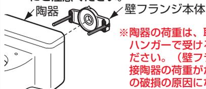
※陶器の荷重は、取付ボルトやバックハンガーで受けるように施工してください。(壁フレンジのボルトに直接陶器の荷重がかかると、フレンジの破損の原因になります)
