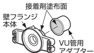
※VU管用アダプターを先に塩ビ排水管に取り付けると、VU管用アダプターが所定の位置に取り付かず、壁と陶器の間にすき間が発生したり水漏れの原因になります。
