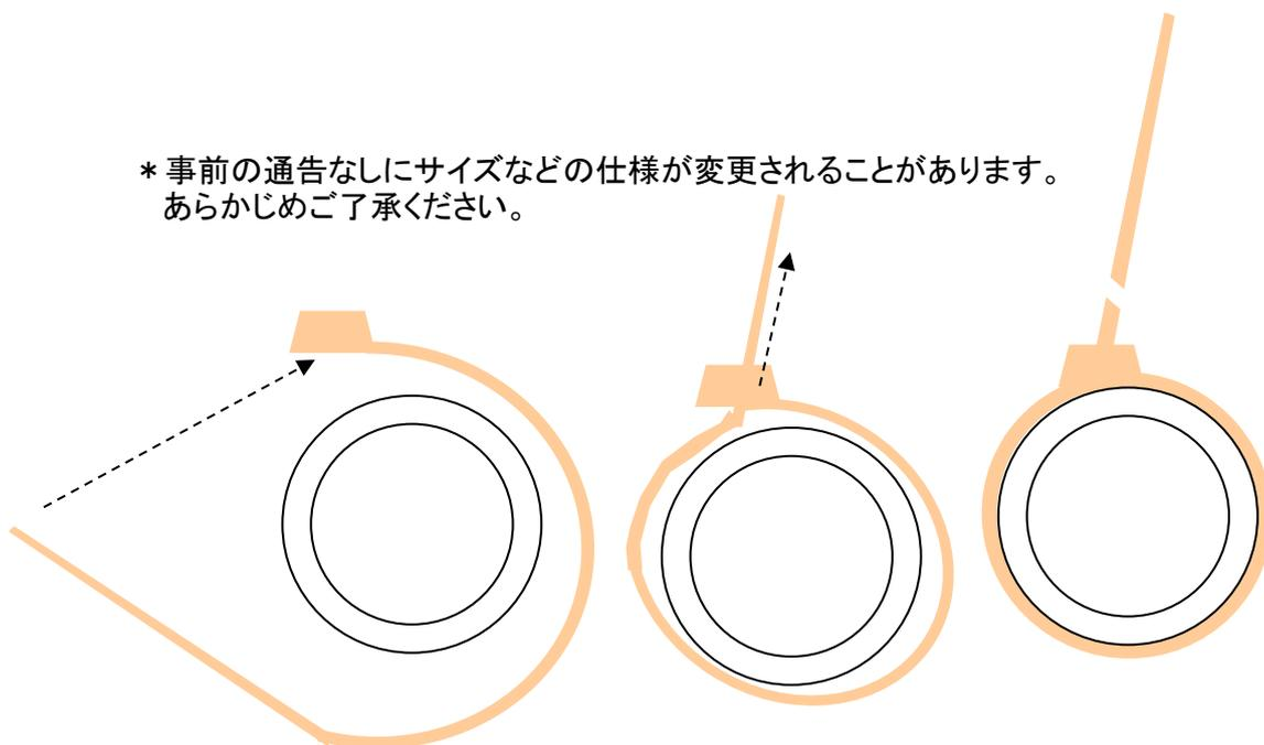
対象物に図の方向でバンドを巻き付け、ロックハウジングにバンドの端を差し込み、バンドを引き絞って緩まないことを確認してから、不要なバンドの端末を鉋などでカットします。
