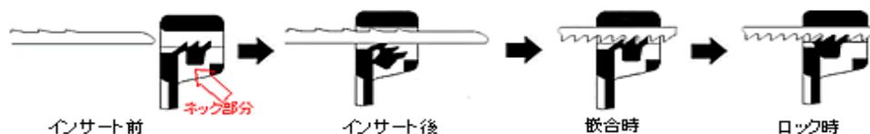
インサート時、ネック部分が可動する機構になっていますので、軽く挿入できます。
