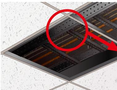
差し込むだけなので、天井裏など高所でも安全に作業できるほか、インシュロックタイを併用するので、付け替えも簡単に行えます。
