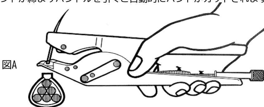
※図Aのように根元でカットされない場合は、調節ねじで調節をしてください。
