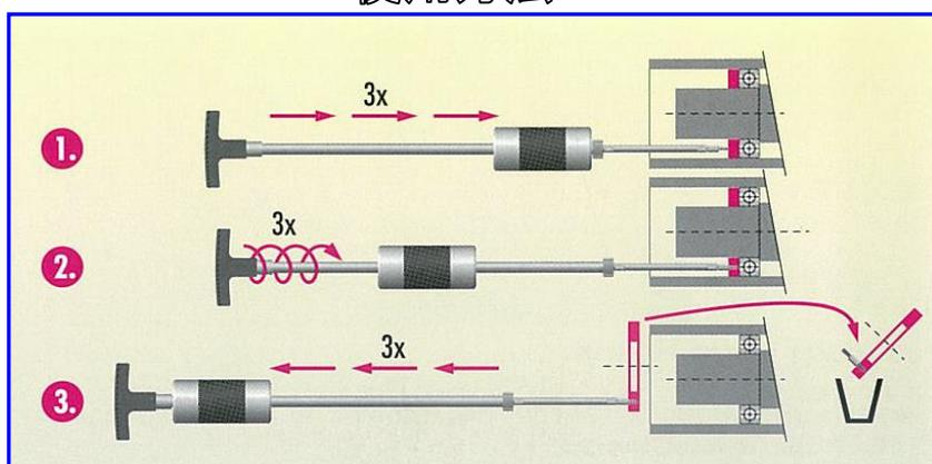
1. 取り外すオイルシールに先端のスクリューを当て3回スライディングハンマーによりシール方向へ衝撃を加える
