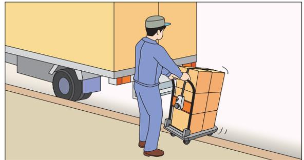
坂道や段差での荷崩れを防止できます。両手で台車を操作できるので、作業者の負荷軽減になります。
