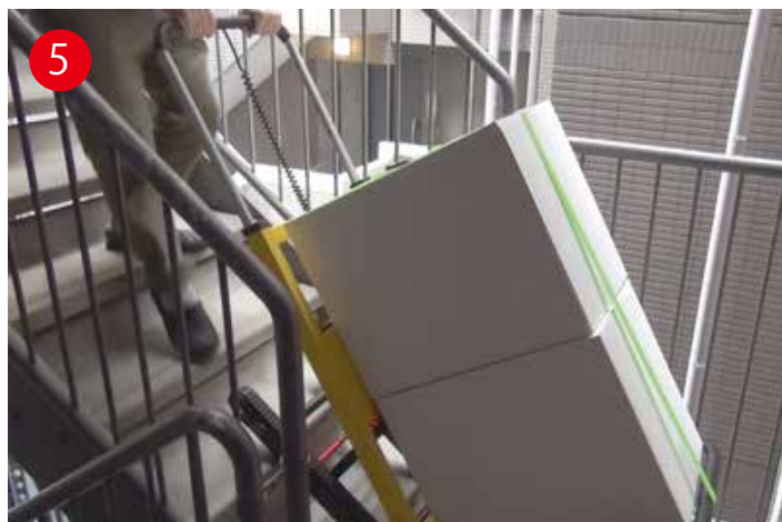
5 走行ベルト全体が階段に付くまで全体を倒します。
