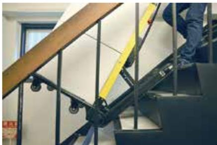
使用できる階段の最大角度は最大 35 度で、走行スピードは、昇降どちらも 8.6m/分 1 分間に約 28 段進めます。コンパクトサイズの台車ですが、最大積載量は 160kg とパワフル。冷蔵庫や洗濯機などの大型家電に、タンスや机などの家具、ビール瓶ケースやペットボトル飲料など、重い荷物を載せても階段を昇り降りできます。
