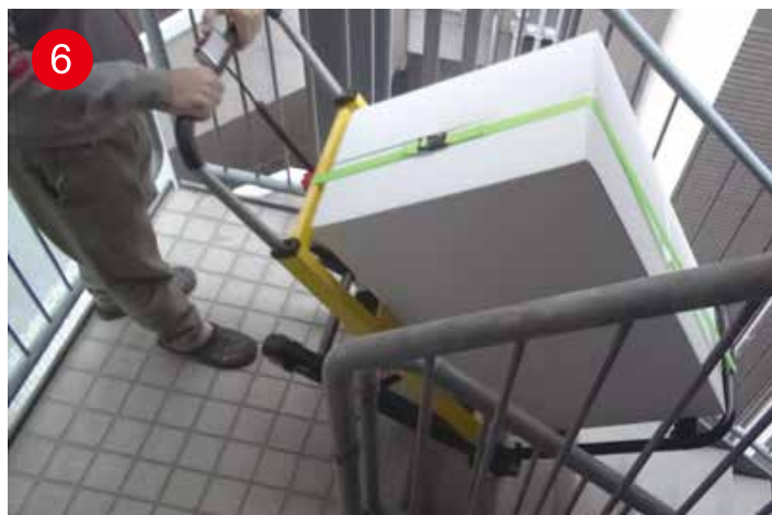
6 降るボタンを押してすこしずつ走行ベルト全体が階段に付くように倒しながら進めます。
