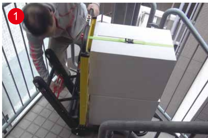
1 階段に合わせて、走行ベルトの角度を調節します。
