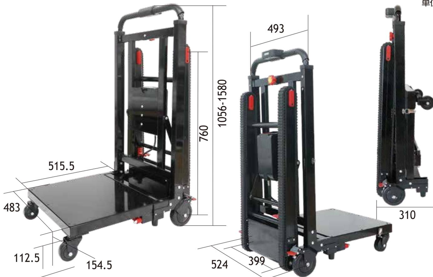
使用できる階段の最大角度は最大 35 度、走行スピードは 3 段階調整可能で約 20 ～ 36 段 / 分となります。最大の特徴は荷台部分を折り畳み可能なことです。折り畳み時は幅約 30cm となるので、使用しない時はコンパクトに片付けておくことができます。最大積載量は 150kg とパワフル。冷蔵庫や洗濯機などの大型家電に、タンスや机などの家具、ビール瓶ケースやペットボトル飲料など、重い荷物を載せても階段を昇り降りできます。
