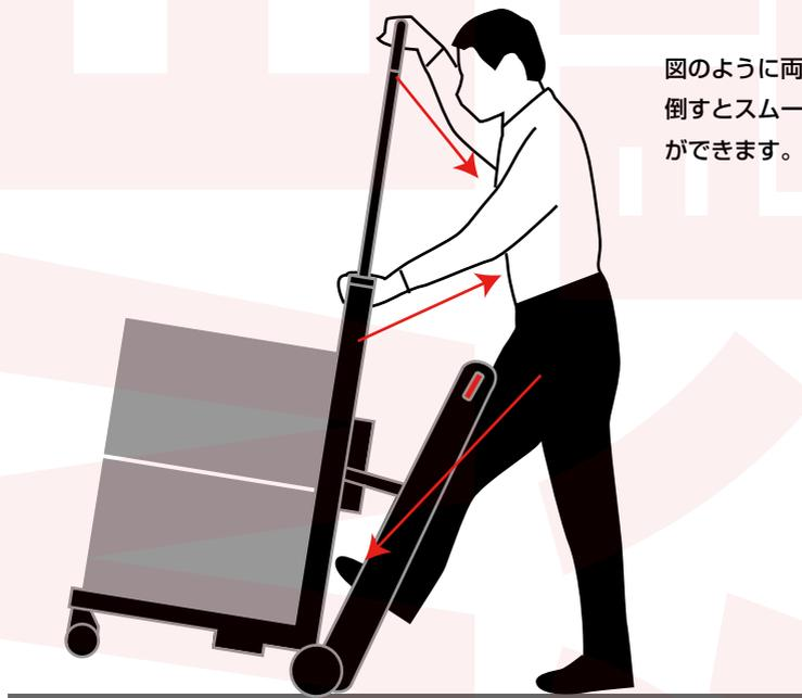
図のように両手を置き、足も使って倒すとスムーズに台車を傾けることができます。
