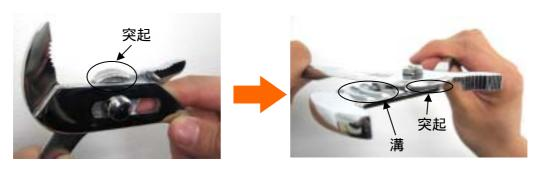
溝と突起が噛み合い、ボルトに負荷がかからず強力な締め付けが可能です。
