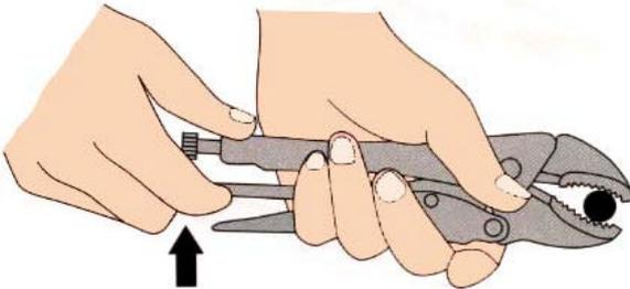
調整ねじを回して口幅が自由に変更できますが、締め過ぎるとロックできなくなったり物を損傷したり、緩め過ぎるとロックはできても、ぐらぐらして用をなしません。
