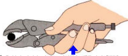
ロックの外し方は、レバーを押してロックを解除してください。
