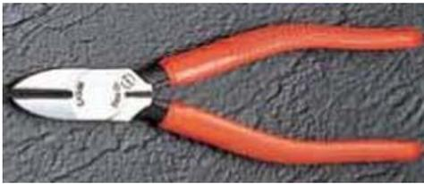
このニッパーは特に刃物強靱性や刃部硬度など高く、かつ長持ちするよう特殊な熱処理を施しています。ピアノ線やスプリング線・ステンレス線など切断するのに最適です。成型カバーを柄部に被覆したものです。
