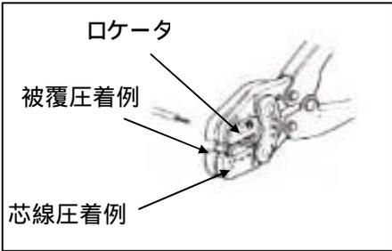
注) 丸型、先開型以外は、ロケータを外して圧着してください。
