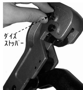
ローター-ダイスに端子をセットし、オンダイスで軽く保持します。(端子は口付け部に、スリーブは中心の正しい位置にオンダイスがあたるようにセットしてください。)
