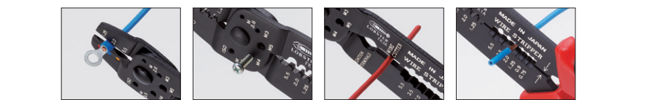
絶縁端子圧着歯口 (1.25、2、5.5mm) ボルトカッター ワイヤーカッター ワイヤーストリッパー (適用サイズM2.6～M5) (適用サイズ0.75～5.5mm)
