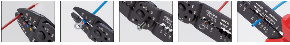
ワイヤーカッター 絶縁端子圧着歯口 (差込端子1.25、2、5.5mm) ボルトカッター (適用サイズM2.6～M5) 裸圧着端子、P.Bスリーブ 用圧着歯口 ワイヤーストリッパー (1.25、2、5.5mm) (適用サイズ0.75～5.5mm)
