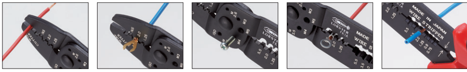
ワイヤーカッター オープンバレル端子圧着 歯口(差込端子1.25、2mm) ボルトカッター (適用サイズM2.6～M5) 裸圧着端子、P.Bスリーブ 用圧着歯口 ワイヤーストリッパー (1.25、2、5.5mm) (適用サイズ0.75～5.5mm)
