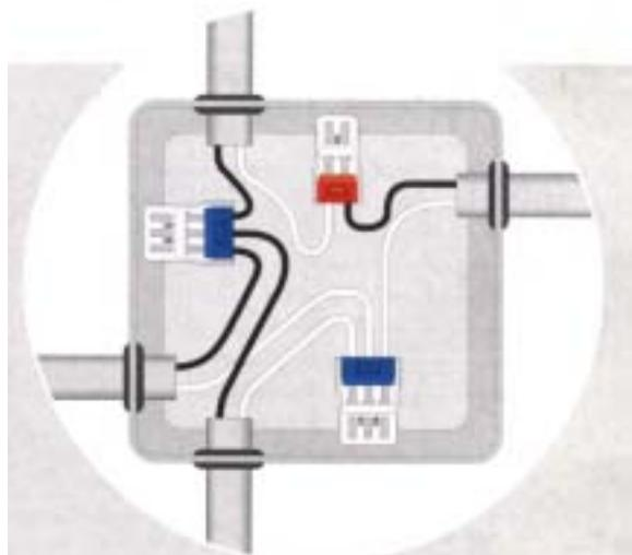
クイックロックは、屋内配線用差込形電線コネクタで電線を差込むことで接続されます。
