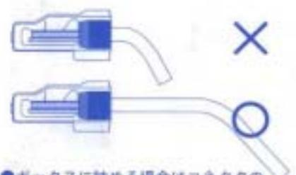
●ボックスに納める場合はコネクタの電線挿入口近くで折り曲げないで下さい。
