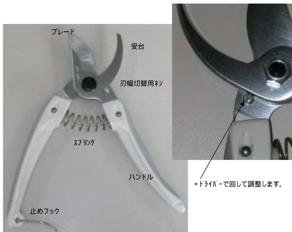
+ドライバーで回して調整します。
