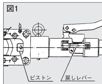
2. 掛け金または抜き差しピンを外し、ヘッドカッタ部を開いて、被切断物をヘッドカッタの切刃部に入れます。
