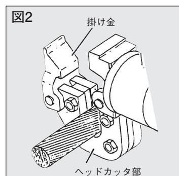
3. 被切断物を入れたまま、ヘッド部を閉じ、掛け金または抜き差しピンを完全に掛けます。（S-320Aはリリースノブを右側へまわす）
