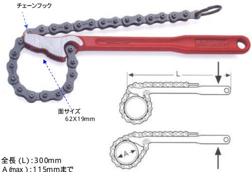
主長 (L):300mm A (max):115mmまで B (本体幅):19mm C (チェーン幅):8mm
