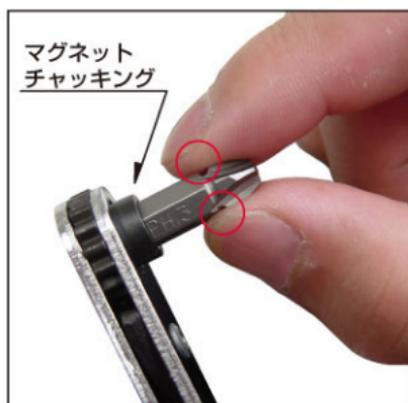
ビットの溝が引抜く際におこる指先の滑りを防止。またマグネットチャッキングによりスムーズなビットの脱着ができます。
