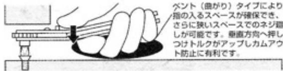
ベント（曲がり）タイプにより指の入るスペースが確保でき、さらに狭いスペースでのネジ回しが可能です。垂直方向へ押しつけトルクがアップしカムアウト防止に有利です。
