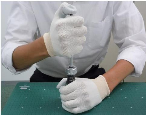
卓上などで、グリップエンドを安定した面に接触させ、垂直方向に差込口を向けます。
