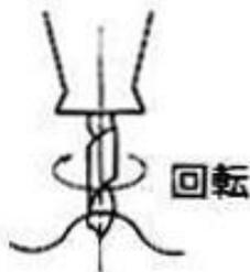
錐先が出たら軽く押し付け回します。
