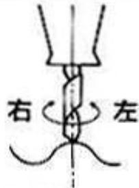
波板の山の部分に錐をあて、先が出るまで左右に押し付けて回します。
