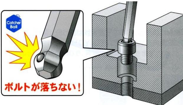
HRC60の硬度を有する鋼球を使用しているため、何度使っても磨り減る事がなく、ボルトをしっかりホールドします。
