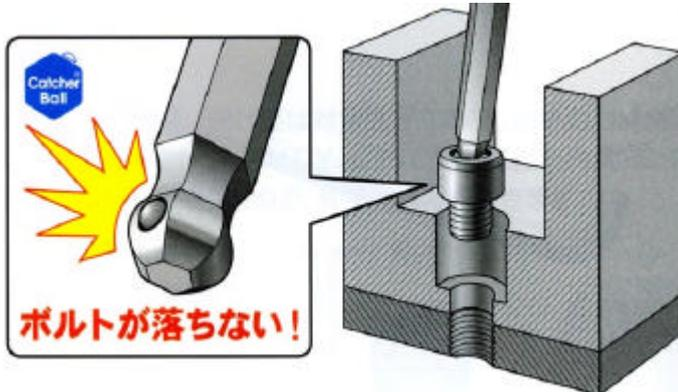
HRC60の硬度を有する鋼球を使用しているため、何度使っても磨り減る事がなく、ボルトをしっかりホルドします。
