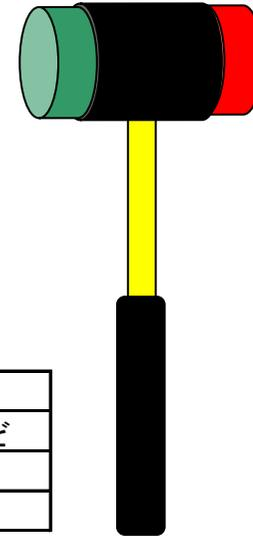
交換ヘッド頭径 φ25mm 厚さ 18mm
