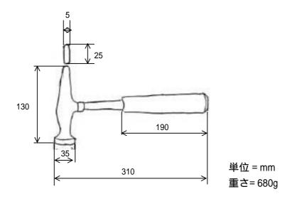
ハンマー頭部の材質: 炭素工具鋼 (S-53C)
