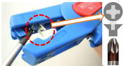
③上刃の取り外し、ハンドルを握り込み、僅かに緩めると上側替刃の固定ねじが確認できます。ポジドライブ#1(PZ1)のドライバーで外して下さい。
