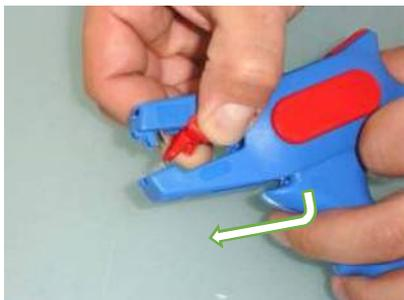
①ストップパーの取り外し、上側調整ストップパーを左右から押して刃に向かって押し出し、ガイドレールから取り外します。
