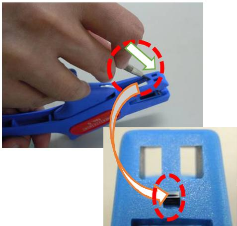
②下刃の取り外し、下アゴ裏側にある■型穴へマイナスの精密ドライバーなどを差込み、下側替刃を押し出して取り外します。
