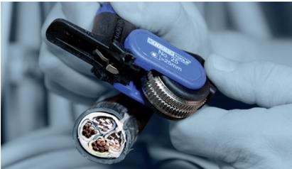
Mit Hilfe der Einstellschraube kann die Schnitttiefe (0-5 mm) auf den jeweiligen Außenmantel angepasst werden.
