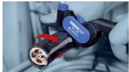
Das Messer kann stets zwischen Längs- und Kreischnitt abgedreht werden.
