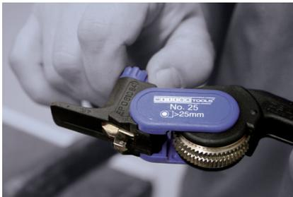
Die Klinge kann durch Auf- bzw. Zudrehen der Einstellschraube ausgetauscht werden. Jede Klinge ist beidseitig verwendbar.
