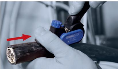
Das Schneiden der Außenisolation erfolgt durch kleine Hebelbewegungen und gleichzeitiges Andrücken der Verzahnung an die Isolation.
