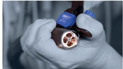
Zu Beginn jedes Längs- bzw. Kreischnittes wird das Messer durch leichtes Andrücken mit dem Finger geführt.
