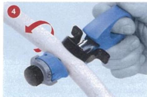
Gerät auf die Markierung der Abisolierlänge aufsetzen und den Rundschnitt durchführen.
