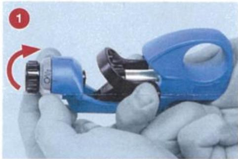
Abisoliergerät entsperren durch Drehen vom Stellung auf das Symbol Rundschnitt (⊙).
