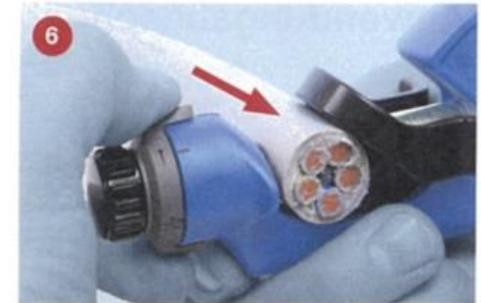
Für Längsschnitt: Stellung auf das Symbol Längsschnitt (→) umstellen und Gerät axial in Längsrichtung ziehen.
