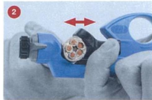
Das Gerät mittels Federkraft an das Kabel spannen.
