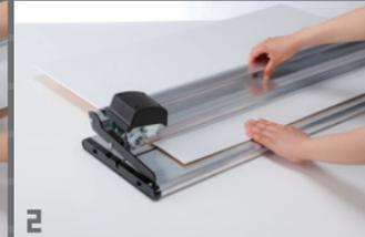
2 レールを倒し、ボードのカットしたい部分を裁断位置に合わせます。
