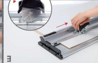
3 スライダーを押し込みながら矢印の方向へ動かし、ボードを裁断します。
