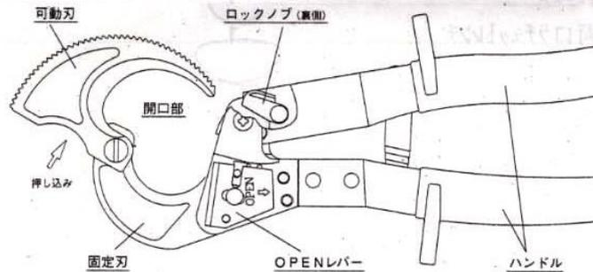
1. ロックノブを外し、可動刃を押し出すか、OPENレバーを矢印方向へ引き下げることによって可動刃を図のようなニュートラル状態にします。
