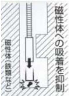
磁力ガードによりマグネット部側面の磁力が抑えられ、磁性体を気にせずピンポイントで対象物まで届きます。
