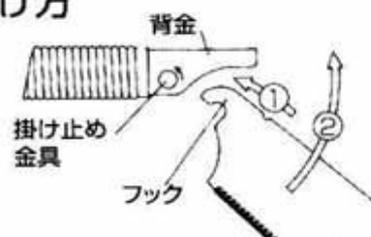
替刃のフックを背金の掛け止め金具に掛けて(矢印1)、矢印2の方向へ押し込み仮止めして下さい。
