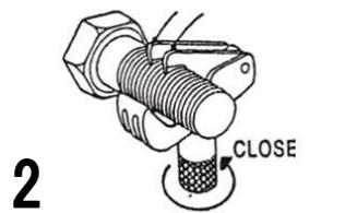
3. ボルトを中心に本体を図の方向に回転させます。
