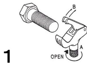
2. 本体に修正するボルトをはめ、刃をネジ溝に下げるために、ハンドルAを図2の様に軽く締める。
