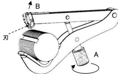
2. 本体に修正するボルトをはめ、刃をネジ溝に下げるために、ハンドルAを図2の様に軽く締める。
