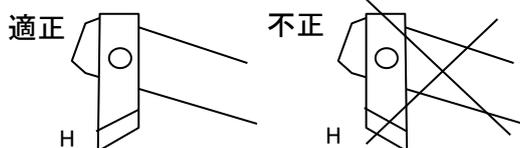
※当製品は片方の刃を反対方向に付け替えて、短いパイプのネジ等も修正できます。
