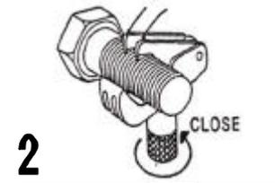
3. ボルトを中心に本体を図の方向に回転させます。
