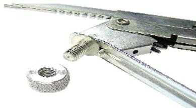
図3 ナットの取外し
