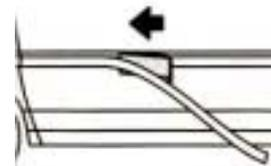
◇口割りがないため、サイドモール等の接着部品の取外しに最適。
