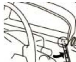
◇インストルメントパネルのクラスタ取外し時等、インパネ側に干渉しないよう底部に丸みを持たせたナロウタイプ
