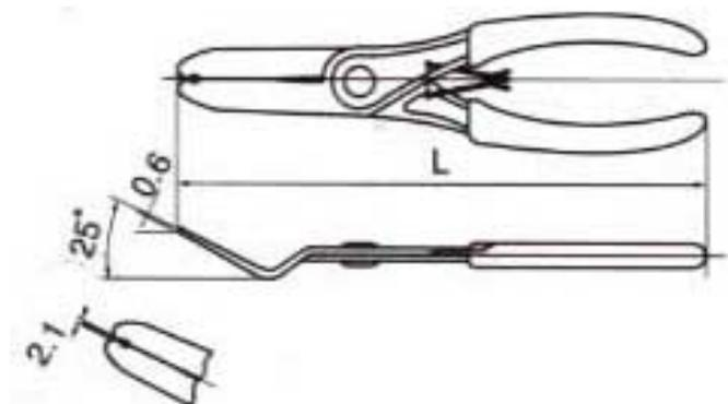
先端部に設けた半径3.5mmのあわせ穴によりクリップの軸部を保持できます。
